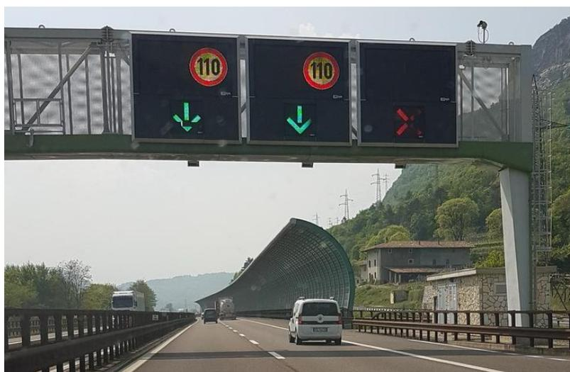
Figura 12: Limiti di velocità dinamici esposti nel tratto BLEC-ENV.
