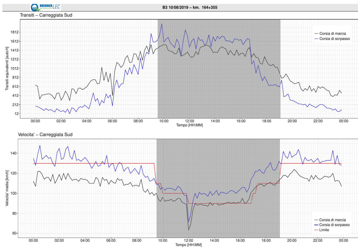
Figura 25: Andamento temporale dei transiti di veicoli leggeri e delle velocità medie misurati presso la spira al km 164 nella giornata del 10/08/2019.
