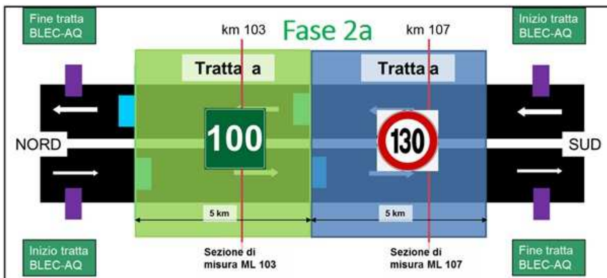
Figura 2: Allestimento del sito di test BLEC-AQ per la seconda fase di test con i limiti dinamici di velocità per fini ambientali utilizzato da luglio 2018 fino a novembre 2018.
