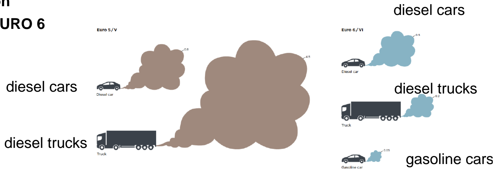
Abbildung 2: Durchschnittliche Emissionen von Stickoxid (NO x ) Euro V und Euro VI Lkw sowie Euro 5 und Euro 6 Diesel-Pkw unter realen Fahrbedingungen (in g/km). Zum Vergleich auch die Emissionen eines Euro 6 Benziner-Pkws.
